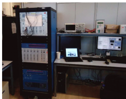
图 10 硬件在环测试平台
