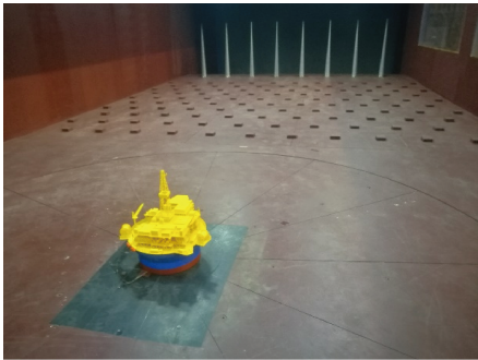
图 1 风载荷试验示意图 Fig. 1 Schematic of wind load tests
