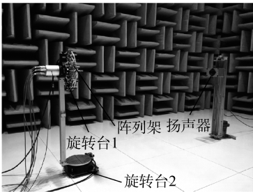
图 7 消声室测试系统 Fig. 7 Measurement system in anechoic chamber
